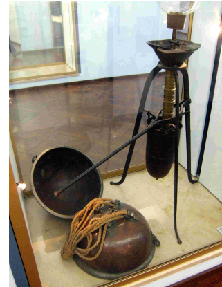
Schéma des hémisphères de Magdebourg, et un dispositif expérimental. (Wikipédia)
