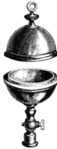
Schéma des hémisphères de Magdebourg, et un dispositif expérimental. (Wikipédia)
